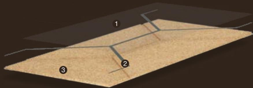
1 Protection CORKGUARD® à base d'eau 2 Couleur imprimée 3 Liège aggloméré usiné CNC
