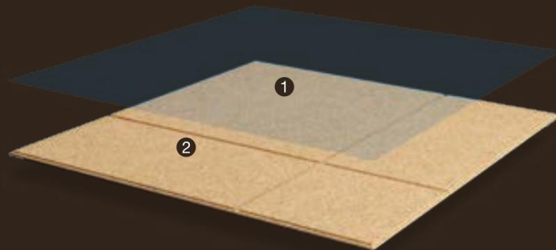
1 Protection CORKGUARD® à base d'eau 2 Liège aggloméré usiné CNC
