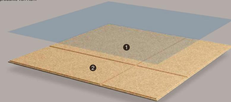
1 CORKGUARD® wasserbasierter Oberflächenschutz mit CleanSurface-Technologie 2 Presskork, CNC-gefräst
